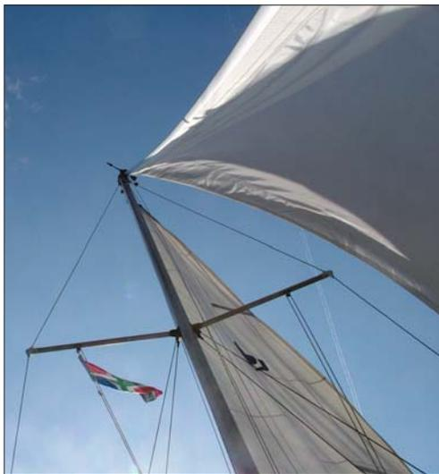
**Парус** – ткань или пластина, прикрепляемая к средству передвижения и преобразующая энергию ветра в энергию поступательного движения.
