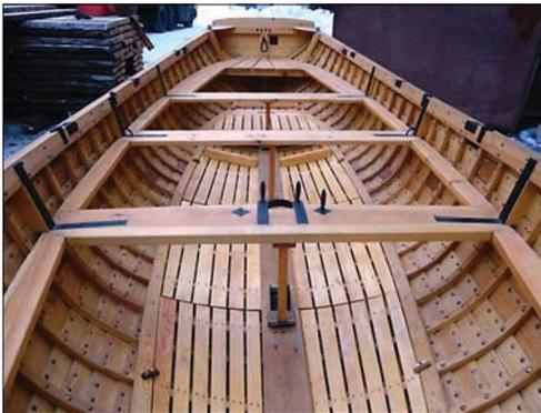
На дно яла укладываются съемные щиты – **рыбины**. Они служат для распределения нагрузки и удобства передвижения по шлюпке. Сверху рыбины имеют поперечные дубовые
