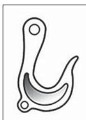
**Пентер – гак** применяется для постановки и уборки тяжелых деталей (тралов, якорей ит.п.). Он представляет собой простой гак, на спинке которого имеется обухок для крепления оттяжки.
