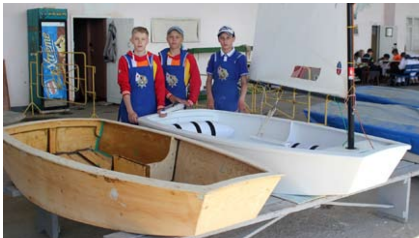
Деревянные корпуса швертботов «Оптимист» в разных стадиях постройки (Международный детский центр «Артек»)
