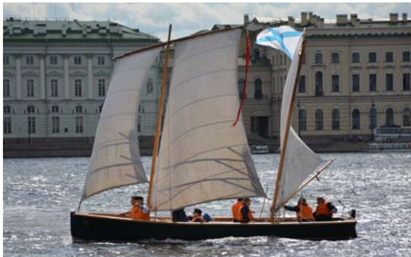
Двухмачтовая парусная оснастка с разрезным фоком. Последний за свою форму моряки в шутку называют «штанами»
