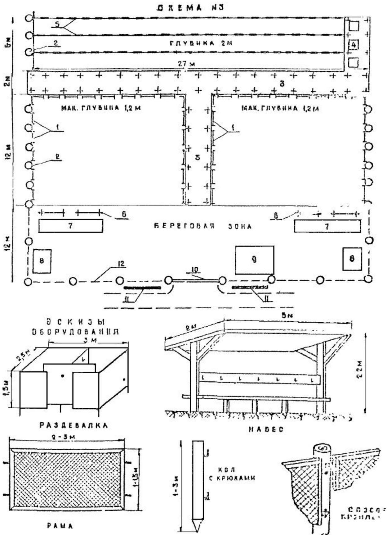
При ограждении по схеме N 1 по периметру акватории через 3-5 метров вбиваются в дно металлические трубы (деревянные сваи, столбы, колья) диаметром 6-10 см, верхняя часть
